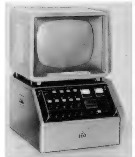
Bild 2. 43-cm-Sichtgerät mit Bedienungspult für Fernseh- und Fotokamera-Fernsteuerung
