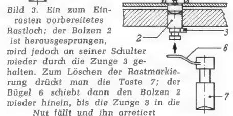
Bild 3. Ein zum Einrasten vorbereitetes Rastloch; der Bolzen 2 ist herausgesprungen, wird jedoch an seiner Schulter wieder durch die Zunge 3 gehalten. Zum Löschen der Rastmarkierung drückt man die Taste 7; der Bügel 6 schiebt dann den Bolzen 2 wieder hinein, bis die Zunge 3 in die Nut fällt und ihn arretiert
