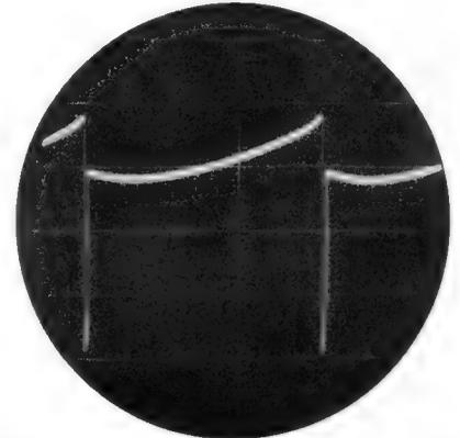
Bild 12. Richtiger Gitter-Steuerimpuls mit parabel-förmigem Anstieg
