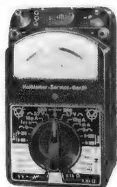
Ein Prüfgerät für Transistoren aller Art
