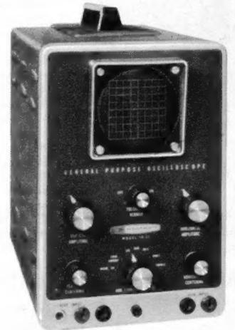
**Technische Daten:** Verstärker: X = Y (2 dB von 2 Hz ... 200 kHz); Empfindlichkeit: 0,25 Veff / Raster-Teilung; Eingangsimpedanz: 10 MΩ 20 pF; 7/cm-Kathodenstrahlröhre 3 RP-1 mit kontrastreichem, abnehmbarem Meßraster; Netzanschluß 220 V / 50 Hz / 40 W; Maße: 245 x 170 x 255 mm; Gewicht: 4,2 kg.
