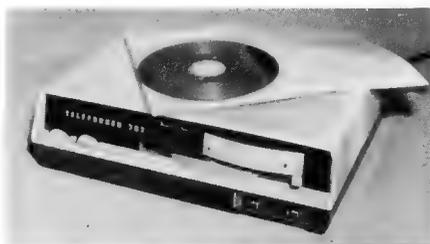
Oben: Bild 1. Telefunken-Diktiergerät Typ 707 für Netzananschluß. Die Diktatfolie wird mühelos in den Schlitz an der Vorderseite eingeführt. Oben eine Sichttasche für die Diktatunterlagen mit einem Fach für die Diktatfolie
